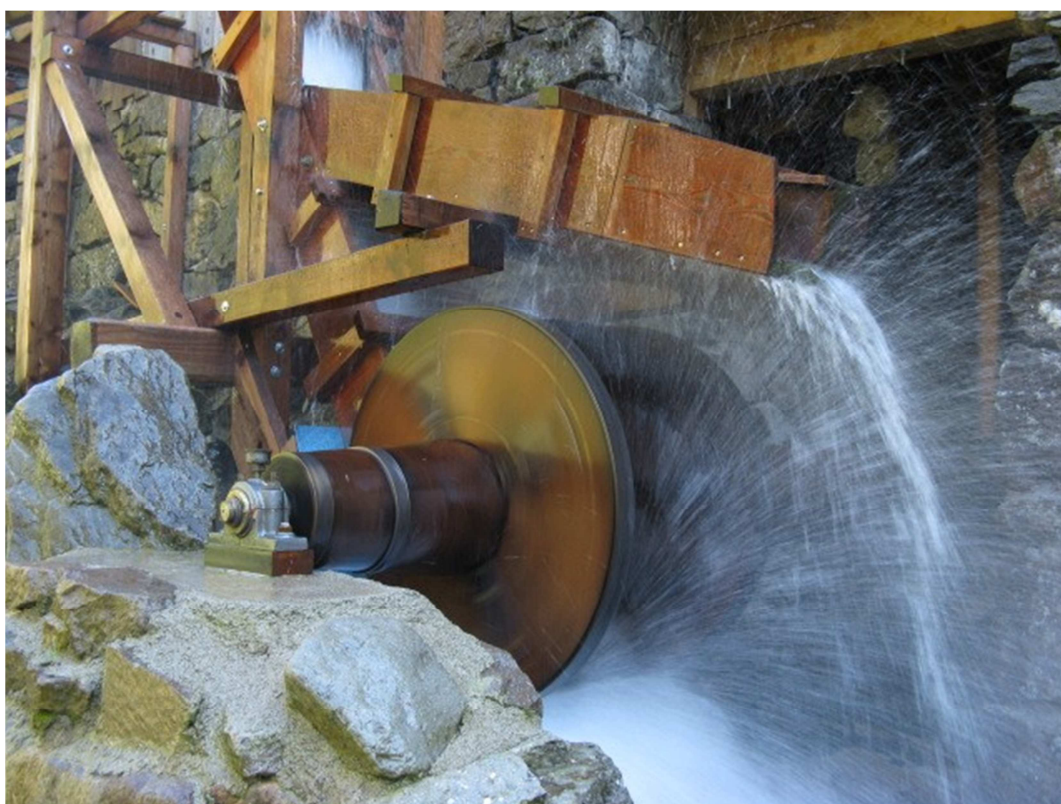
Fig. 20 - Uso tradizionale dell'acqua per forza motrice: ruota ad acqua riattata a fini didattico divulgativi presso la segheria storica della Valcava alimentata dal Rio Valcava/Balkof .
