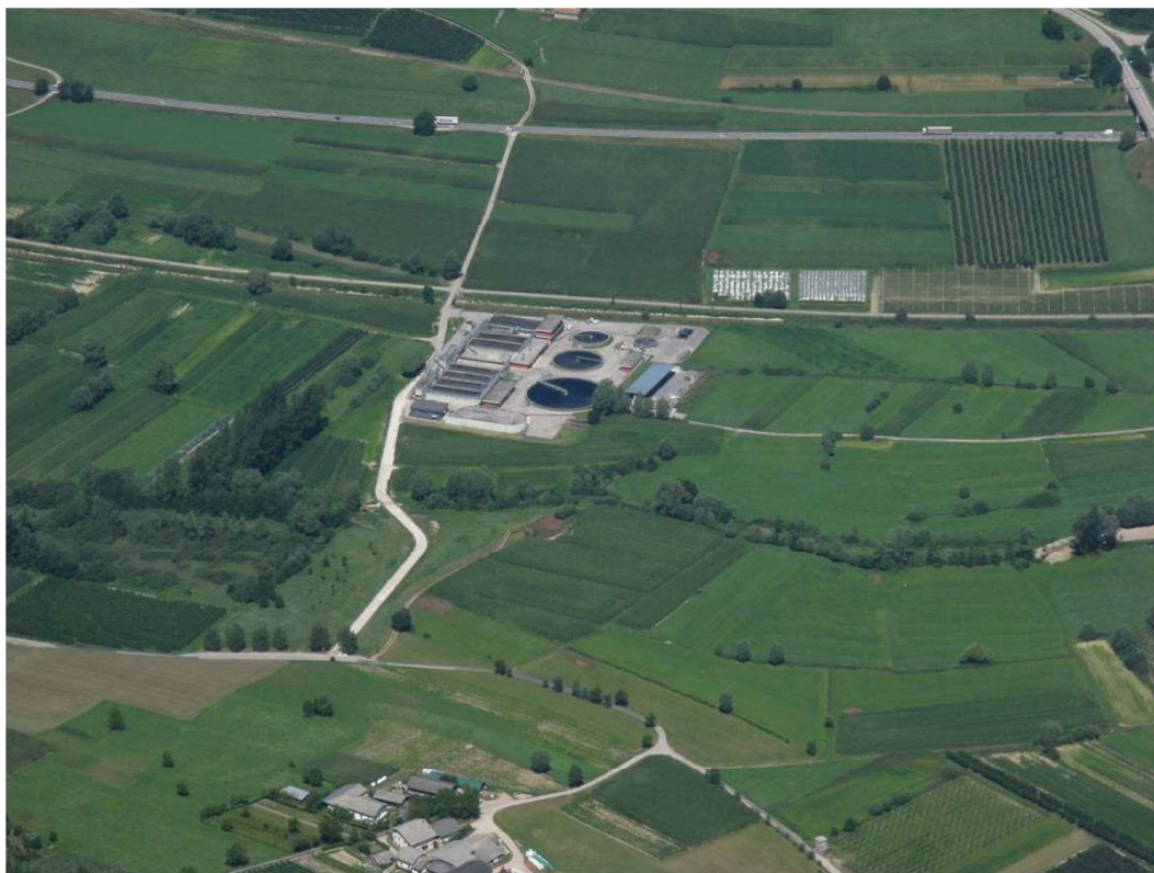
Fig. 32 - Depuratore biologico di Levico, il maggiore degli impianti tecnologici di trattamento delle acque nere interno al territorio dell'Alta Valsugana, che serve quasi 40.000 abitanti equivalenti e scarica le acque reflue nel F. Brenta.
